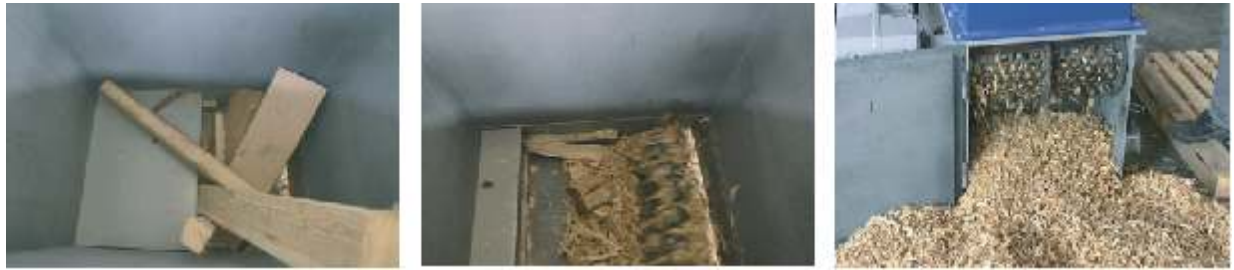
ZWS 600 zur Zerkleinerung von Holzabfällen, z. B. in einer Schreinerei / ZWS 600 for reduction of wood scrap, e.g. in a joinery
