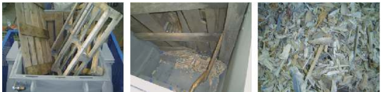
Palettenzerkleinerung mit dem ZWS-Einwellenzerkleinerer / ZWS shredder crushing pallets
