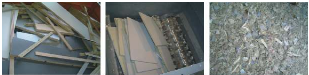
Zerkleinerung von Plattenabfällen mit der ZWS 1100 / ZWS 1100 crushing board waste
